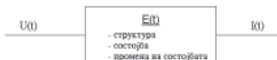
Сл.1 Модел на ситем: U(t) – вектор на влез во системот, I(t) – вектор на излез од системот, E(t) – вектор на трансформација на влезот во излез.
