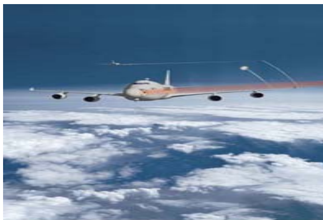
Сл.4 Воздушен хемиски ласер инсталиран на воздухоплов способен да погодува проектили во почетната фаза на летот.
