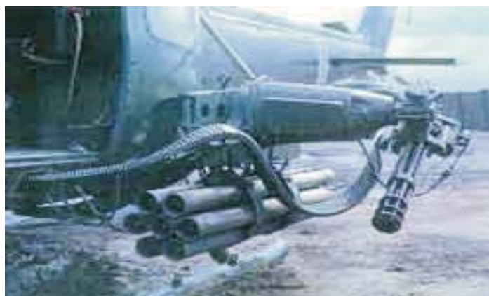
Сл. 5 „ганиган“ М134 поставен на јуришен хеликоптер УН-1 Гро
